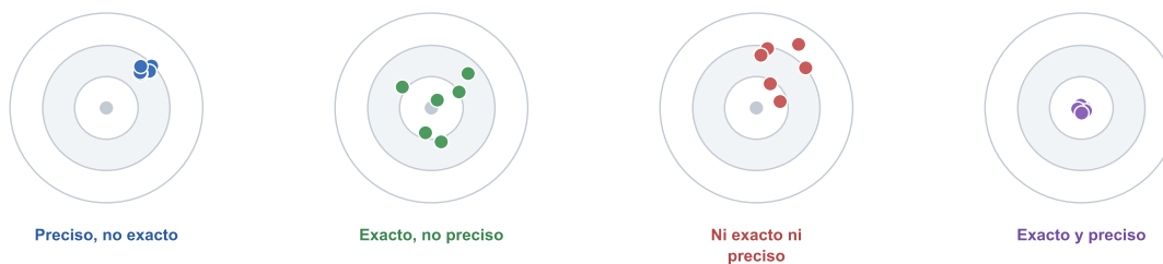
Imagen 4. Combinaciones de exactitud y precisión. Infografía con cuatro dianas alineadas: la primera, con flechas dispersas y lejanas del centro (no preciso, no exacto); la segunda, con flechas agrupadas pero alejadas del centro (preciso, no exacto); la tercera, con flechas dispersas alrededor del centro (exacto, no preciso); y la cuarta, con flechas juntas y centradas (preciso y exacto).
