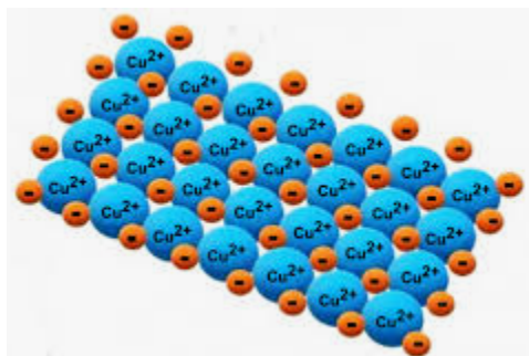
Imagen 11. Red metálica de cobre. (Imagen de referencia). Enlace metálico entre átomos de \text{Cu}^{+2} color 1 y alrededor electrones de color 2.
