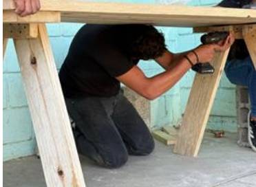
Ensamblando la base con los travesaños
