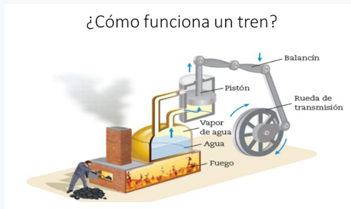
Imagen 115. Funcionamiento de un sistema de tren de vapor. Imagen de referencia.
