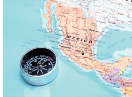
El extremo norte de la brújula es atraído hacia el polo norte de la Tierra (polo sur magnético).
