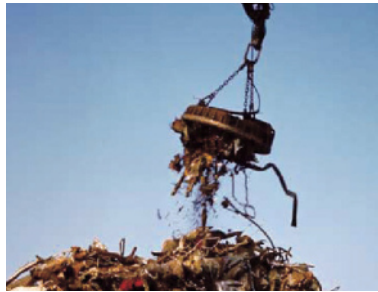
Electroimán de una grúa. Imán temporal que se activa al pasar una corriente eléctrica a través él.
