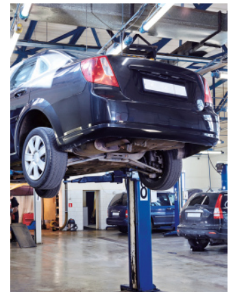
Elevador de autos.
